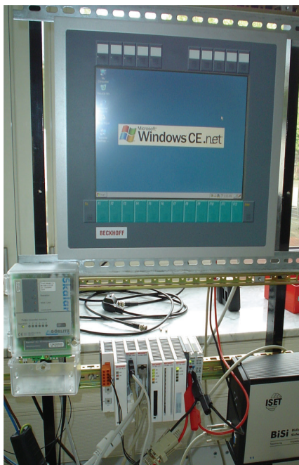
Bild 4: Laboraufbau BEMI mit Rechner, Zähler, Netzsicherheitsinterface und Bedienkonsole (Entwicklungssystem)
